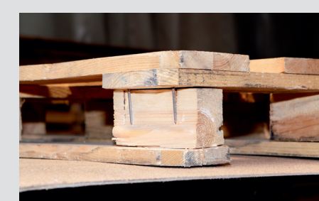
Видимые: острая или более 2 стержней гвоздей на поддон.
