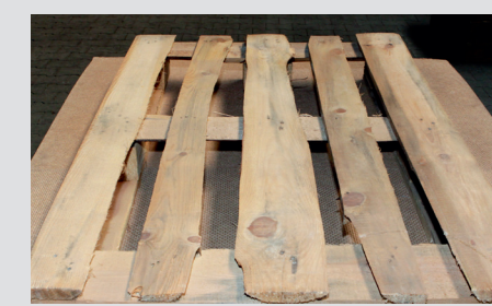
Неприемлемый компонент, который не соответствует Техническому регламенту EPAL, например он меньше, гнилой, блеклый.
