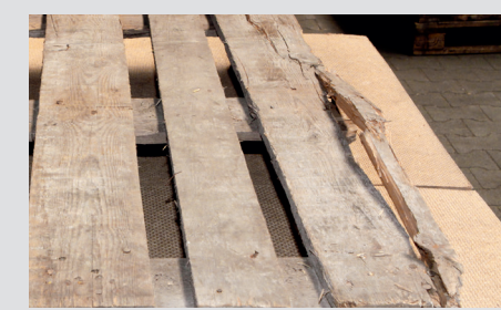
Сломанные поперечины досок, частично или полностью сломанная доска.
