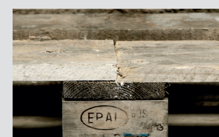
Ремонт не соответствует техническим условиям.
