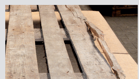
Deska złamana poprzecznie, wzdłuż lub nadłamana
