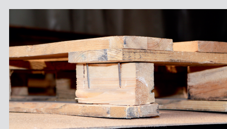
Widoczne ostrza gwoździ lub ponad 2 trzpienie gwoździ na paletę
