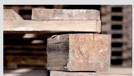
Wspornik przekrzywiony > ok. 1 cm
