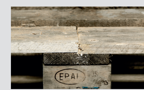
Réparation non conforme
