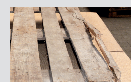
Planche cassée entièrement ou partiellement
