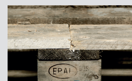
Reparatii care nu corespund specificatiilor
