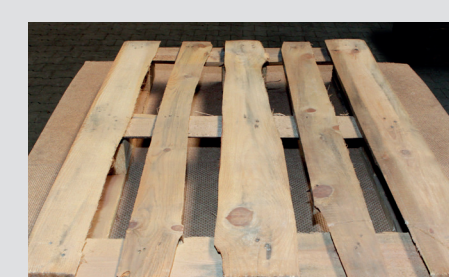
Elemente neconforme care nu respecta reglementarile tehnice EPAL, de ex. elemente subdimensionate, putrede, tesitura in exces.
