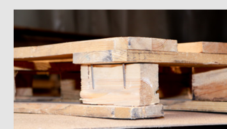
Zichtbare spijkersporen of meer dan 2 spijkersporen per pallet.
