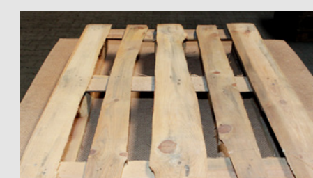
Onaantvaardbaar onderdeel dat niet voldoet aan de technische voorschriften van EPAL, b.v. ondermaats, verrot, waankanten.
