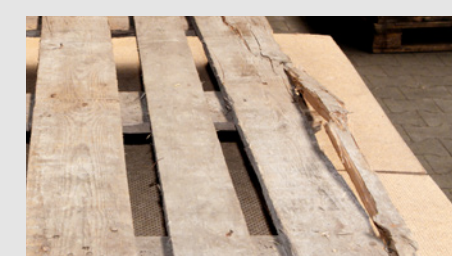
Dwars, gedeeltelijk of volledig gebroken planken.
