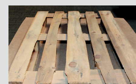
Vastuvõetamatu komponent, mis ei vasta EPAL-i tehnilistele eeskirjadele, nt liiga väike, mädanenud, poomkandiga jne.
