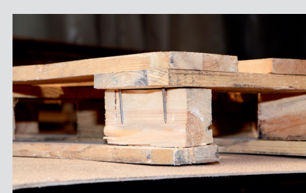
Nähtavad naelaotsad või rohkem kui kaks naela kaubaaluse kohta.
