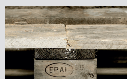
Nõuetele mittevastav remont
