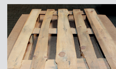
Uacceptabel komponent, der ikke overholder EPAL's tekniske forskrifter, f.eks. underdimensioneret, råddent, bomkant
