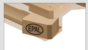
Na jedné podélné straně chybí označení EPAL na obou rohových špalcích.
